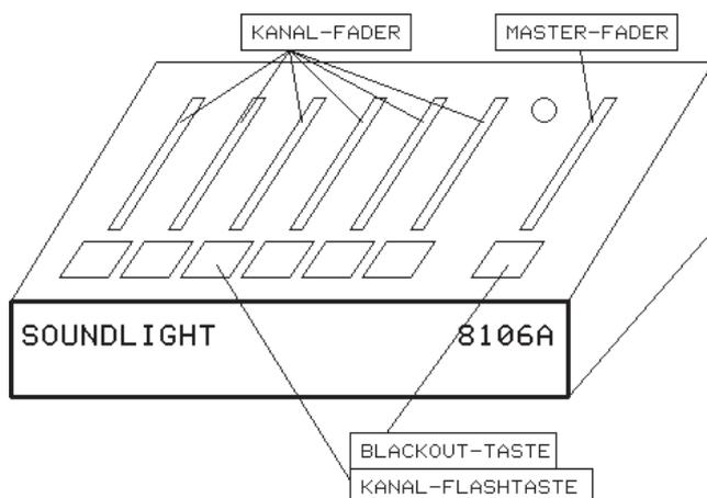
3. Öffnen Sie den Masterfader voll. Mit den Kanalfadern können Sie nun die Lichtstimmung für die
